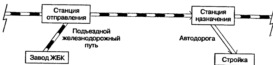
Рис. 2.1. Пример транспортной схемы доставки груза железнодорожным и автомобильным транспортом
